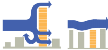
Afbeelding 74: Effect van de aanwezigheid van een toren op de wind in het stadsmilieu (Bron: UCL/CLI (juni 2009). BXXL – “Objectivation des avantages et inconvénients des immeubles élevés à Bruxelles”)
