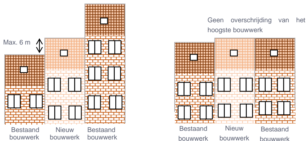
Figuur 154: Verklarend schema van de bij artikel 13 geregelde bepalingen in de eerste 6 m ten opzichte van naastliggende bouwwerken
