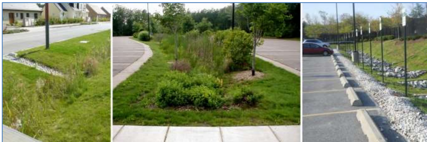
L'aménagement de noues peut contribuer à l'écologie et à la réduction des inondations, sources internet
