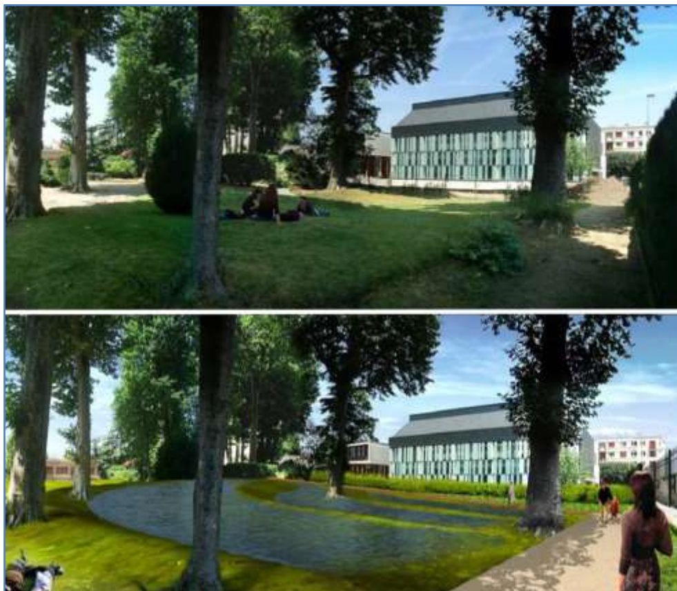
Les espaces publics peuvent localement devenir inondables moyennant une végétation adaptée, source Urban Water
